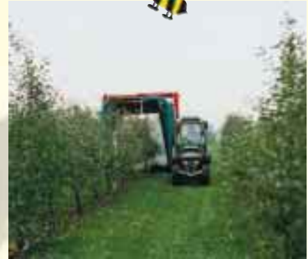
Tunnelspritze zur sparsamen und abdriftarmen Ausbringung von Pflanzenschutzmitteln
